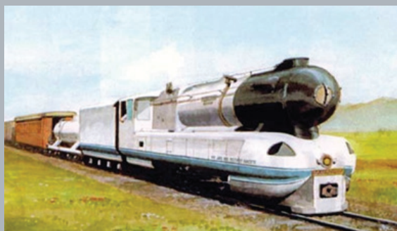
La Locomotora "ARGENTINA" fue una locomotora a vapor tipo 4-8-0 de cuatro cilindros de doble expansión.
